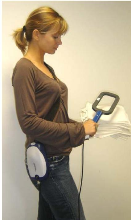
TAGSYS WiFi RFID Inventario de características y diseño único y funcionalidad testada al 100%. A través de la antena se tiene una rápida lectura, con el lector RFID portátil la cual puede leer simultáneamente varios artículos. La transmisión de datos es a través de Wi-Fi a la del sistema de recepción, PC o PDA, evitando las molestias de los cables y aportando todas las ventajas del Wifi. Con un peso ligero, diseño ergonómico,
